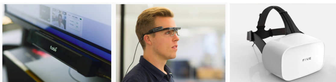
Figura 6.8: Rastreamento ocular de plataforma, com óculos simples, e com óculos especial de realidade virtual
